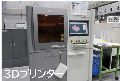
本学の3Dプリンターは、溶かした材料を積層させる一般的なタイプとは異なり、紫外線(UV)で硬化する液体樹脂にUVレーザーを照射して積層させていく「光造形方式」です。造形精度が良く、透明で表面がなめらかなパーツが作製できるため、歯車やインペラなどの機械部品、内部の流体が観察できるパイプなどを造形することができます。特に、金属加工が難しい複雑な造形物をCAD/CAMで設計・図面化し、3Dプリンターで造形を行います。
