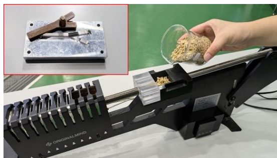
<写真3：金型と成形加工機>
