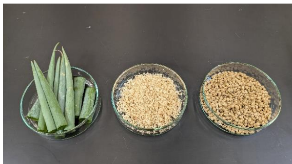
<写真2：ネギの葉、セルロース、樹脂ペレット>
